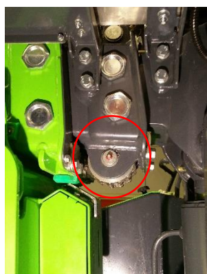
Figura 16: Engrasador de polea de cadena telescópica
