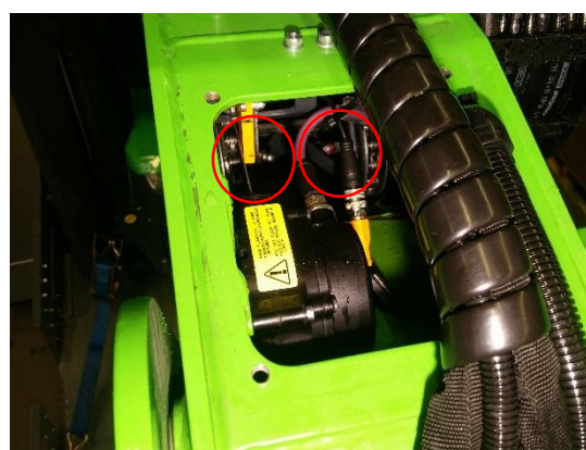
Figura 17: Puntos de engrase de la polea de cadena de la hoja en la parte delantera del 2º brazo.
