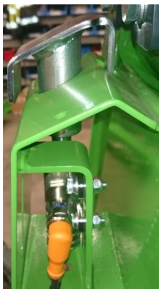
Figura 28: Sensor de soporte de transporte superior
