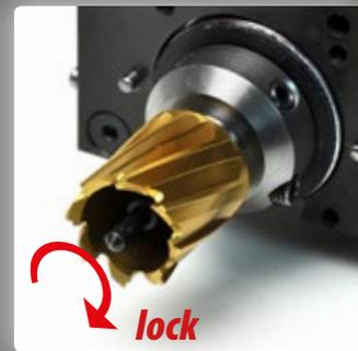
Introducir la fresa en el mandril colocándola para que coincida el **plano de cotejo** situado en el cono con el **pasador transversal** en el interior del mandril, girando entonces en el sentido de las **agujas del reloj**;
