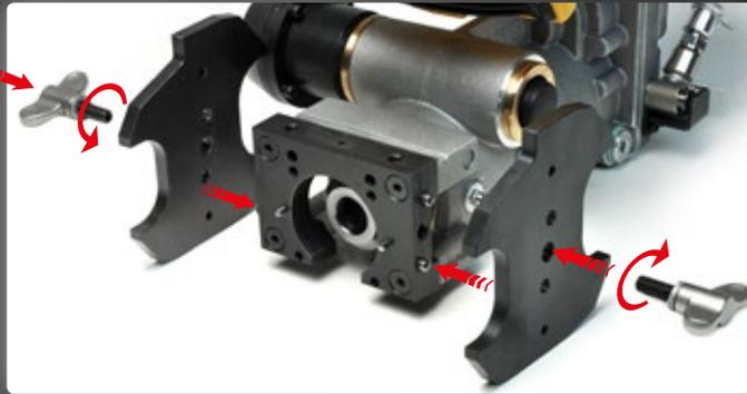
Girar los dos insertos por el mismo lado, adaptado al perfil del carril que se perfora. Montar los insertos en los lados de la placa delantera del taladro haciendo coincidir los pasados con los correspondientes orificios dispuestos en los insertos. Las marcas en los dos insertos deben girarse por el mismo lado.
