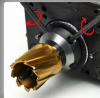
Mediante la palanca, avanzar el mandril para hacer accesibles ambas los tornillos.
