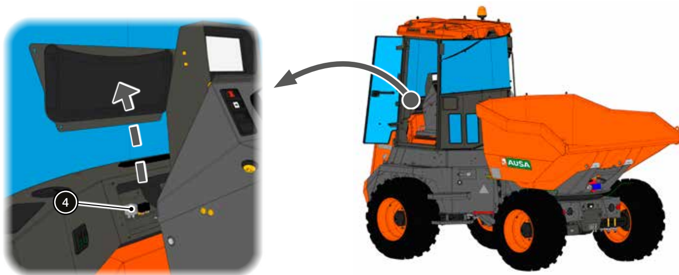
Ubicación de la caja de fusibles de la cabina ACCESORIO
