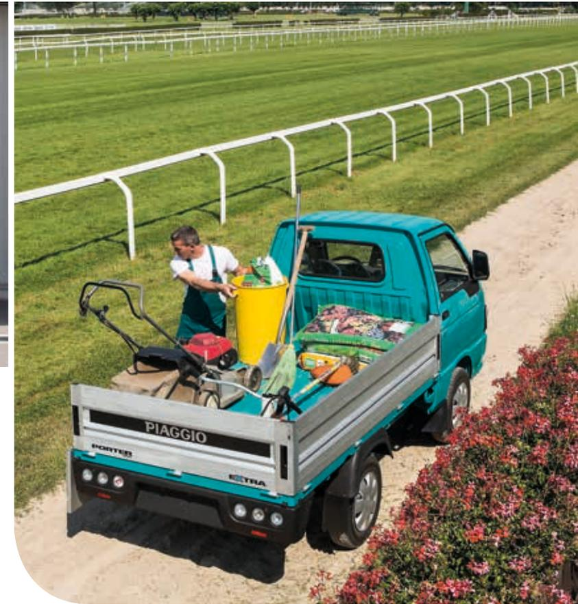
Al estar a tan sólo 715 mm del suelo, se accede fácilmente a la gran plataforma de carga «all flat» y se puede aprovechar en su totalidad. Los tres laterales y la compuerta trasera de aleación se bajan completamente para facilitar las operaciones de carga y descarga, incluso con mercancías voluminosas.
