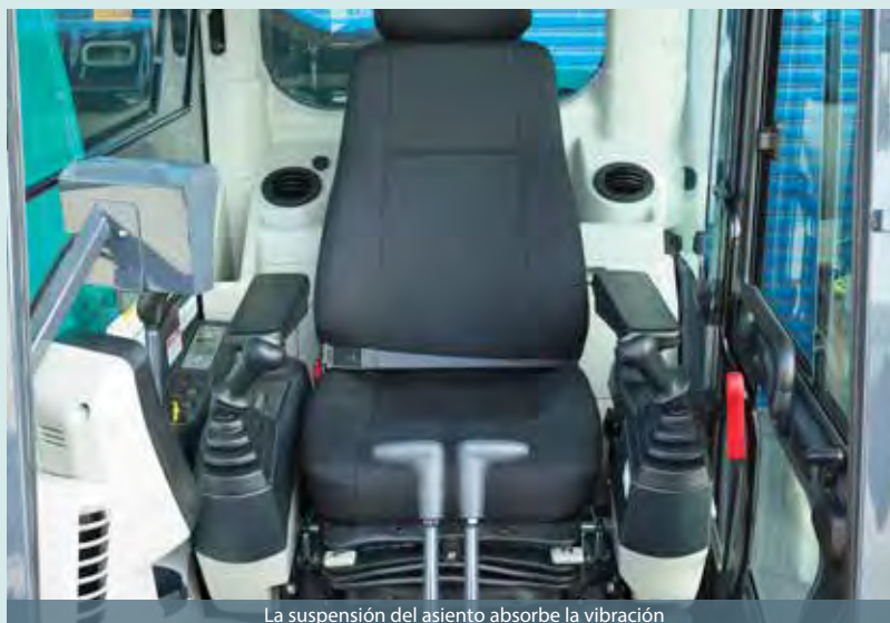
La suspensión del asiento absorbe la vibración
