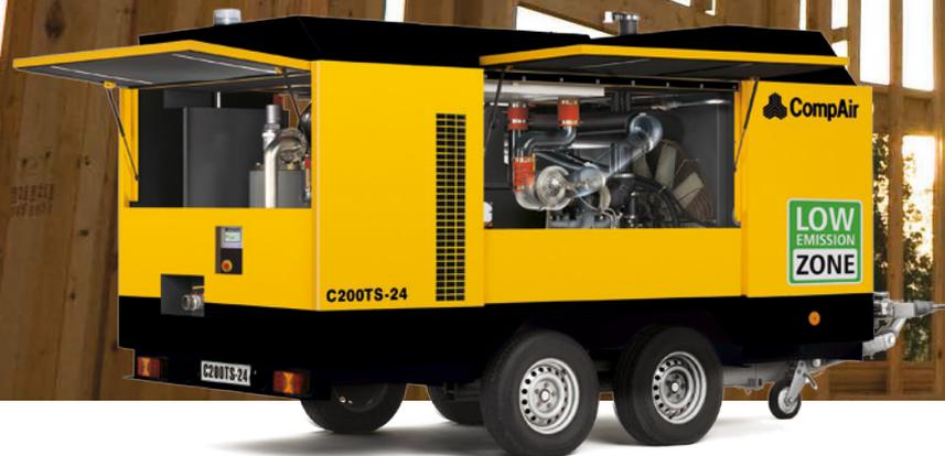
Los compresores TurboScrew con su exclusiva tecnología biturbo, brindan eficiencia diesel líder de la clase, un peso mínimo de 3 500 kg y un funcionamiento super limpio de acuerdo a la directiva de la CE 97/68/EG Etapa 4 final. Los nuevos compresores TurboScrew han sido equipados con el galardonado sistema SCRT® – Tecnología de reducción catalítica selectiva, capaz de eliminar casi todas las emisiones de óxido de nitrógeno de los gases de escape diesel.
