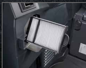
Filtro del aire acondicionado para la admisión del aire exterior
