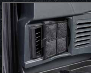
Filtro del aire acondicionado para la circulación del aire interior
