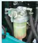
Prefiltro de combustible con separador de agua incorporado
