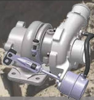
**Turbocompresor con válvula de descarga:** aumenta la densidad del aire, lo que permite al motor producir más potencia sin que influya mucho la altitud. Los gases de escape se desvían de la turbina para regular mejor la presión máxima de sobrealimentación y proteger el motor. También se disminuye el tiempo que pasa antes de que el turbo comience a maximizar el par. Reduce el desgaste en condiciones de altas revoluciones y baja carga.
