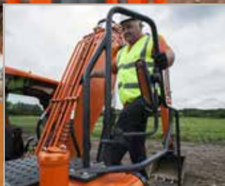
Barandillas de seguridad
