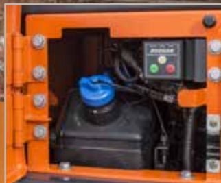
Depósito de reducción catalítica selectiva (SCR)
