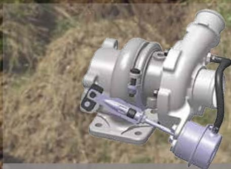
**Turbocompresor con válvula de descarga:** desvía los gases de escape de la turbina para regular mejor la presión máxima de sobrealimentación y proteger el motor. También disminuye el tiempo que pasa antes de que el turbo comience a girar/generar fuerza que maximice el par y además reduce el desgaste en condiciones de régimen elevado y baja carga. El turbocompresor aumenta la densidad del aire, lo que permite al motor producir más potencia sin que influya mucho la altitud.
