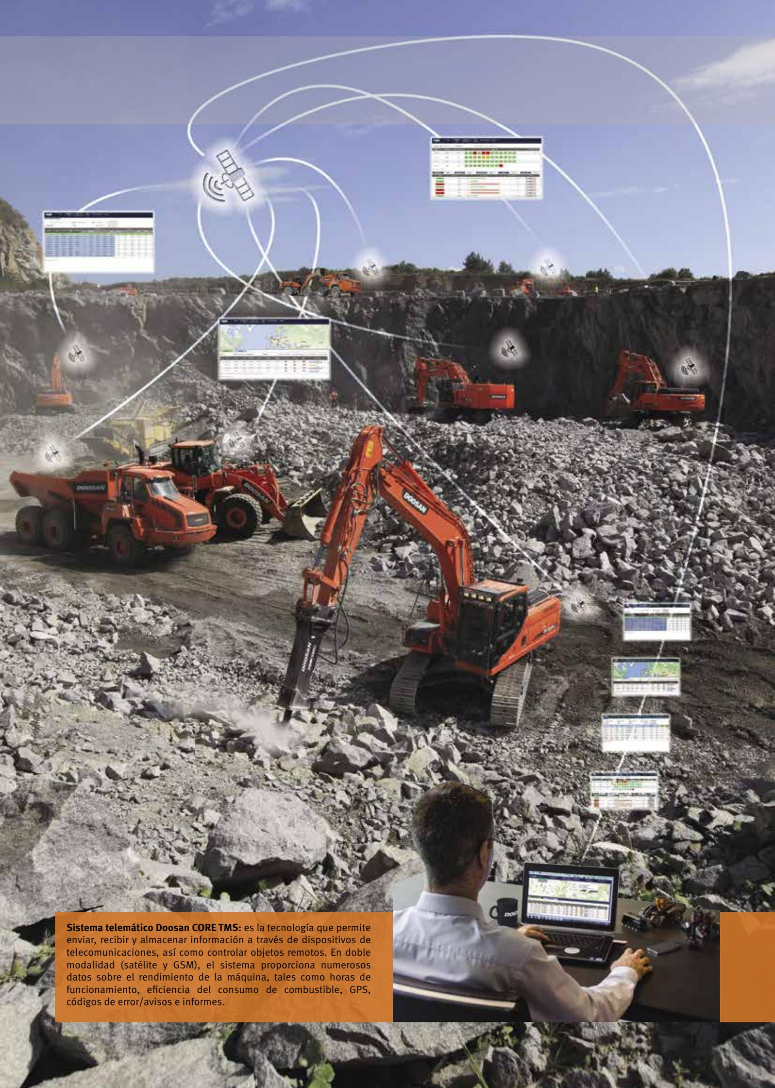
**Sistema telemático Doosan CORE TMS:** es la tecnología que permite enviar, recibir y almacenar información a través de dispositivos de telecomunicaciones, así como controlar objetos remotos. En doble modalidad (satélite y GSM), el sistema proporciona numerosos datos sobre el rendimiento de la máquina, tales como horas de funcionamiento, eficiencia del consumo de combustible, GPS, códigos de error/avisos e informes.
