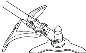
Controle que la protección no esté dañada y que no tenga grietas. Cambie la protección si ha estado expuesta a golpes o si tiene grietas.
