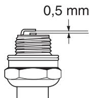
**¡NOTA!** ¡Utilice siempre el tipo de bujía recomendado! Una bujía incorrecta puede arruinar el pistón y el cilindro. Asegúrese de que la bujía tenga supresión de perturbaciones radioeléctricas.
