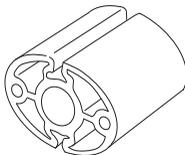
Compruebe regularmente que los elementos antivibraciones no estén agrietados o deformados. Controle que los amortiguadores de vibraciones estén enteros y bien sujetos.
