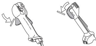
Apriete el fiador del acelerador y compruebe que vuelva a su posición de partida al soltarlo.
