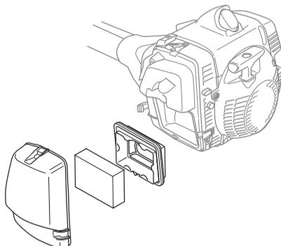
Controle que el filtro esté seco antes de volver a montarlo.
