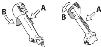
Compruebe que el acelerador esté bloqueado en la posición de ralentí cuando el fiador está en su posición inicial.
