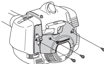
Desmontar el filtro de aire de la máquina y quitar la tapa del filtro de aire. Montar el filtro de aire y la tapa del filtro de aire del kit invernal.
