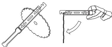
Revise el equipo de corte para ver si está dañado o agrietado. Un equipo de corte dañado debe ser siempre reemplazado.
