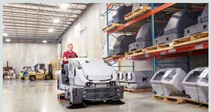
SmartFlow™ ajusta el caudal de solución a la velocidad de la máquina, utilizando menos agua y productos químicos. Alta productividad ya que se reduce el número de vaciados y llenados del depósito.
